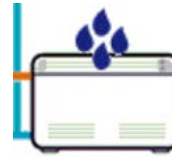
9. ábra: Fancoil berendezések páramentesítő működésben
