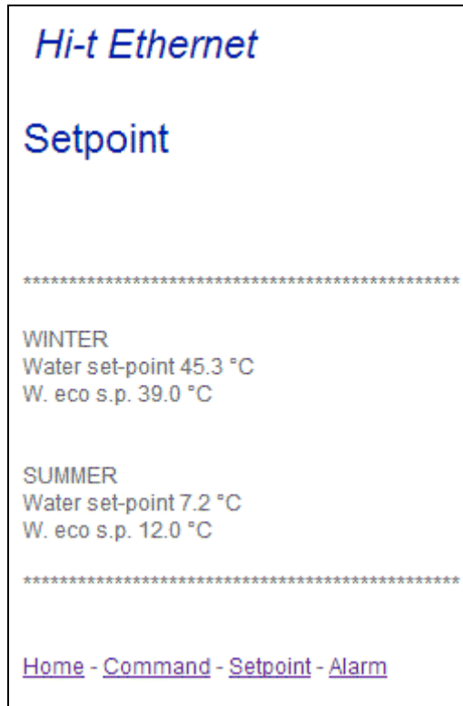
34. ábra: Ethernet Érintőképernyő „Set-point” (Alap-pont) oldal
